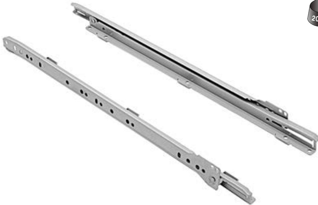
• La fijación CLAMP se consigue por medio del plegado de 3 aletas laterales practicadas en el cuerpo de la guía y garantiza una perfecta sujeción y un apoyo óptimo de la guía al lateral del cajón. Este tipo de fijación permite un rápido montaje de la guía al cajón sin la utilización de tornillos.
