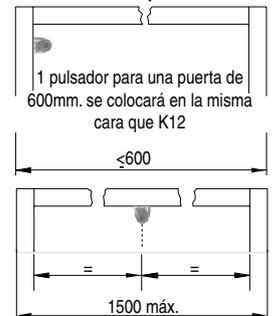
Tabla de medidas para el acoplamiento de bisagra **KIMANA** con el compás **K12**
