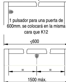
Tabla de medidas para el acoplamiento de bisagra **KIMANA** con el compás **K12**
