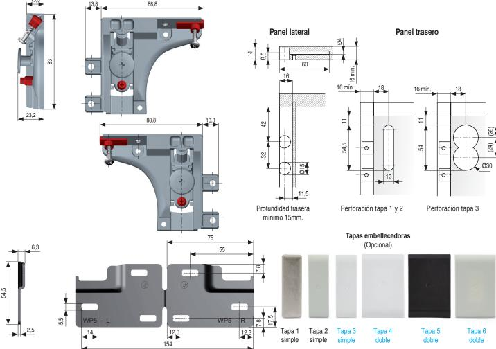
• La placa doble de sujeción se puede partir manualmente por la mitad. Pedir por separado.
