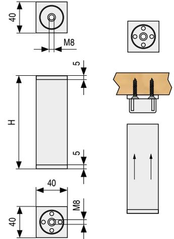
Doble fijación con tornillos rosca madera o con tornillos M8.
