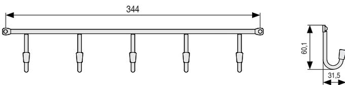
• Para sujeción a la puerta o pared mediante tornillos.
