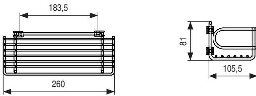
• Para sujeción a la puerta o pared mediante tornillos.
