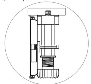
• Para montaje en la ranura del perfil.
