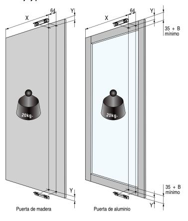
La altura de la puerta es libre, máximo según la medida de la barra de unión o el peso máximo de la puerta de 20kg.
