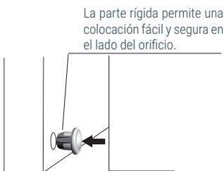
La parte rígida permite una colocación fácil y segura en el lado del orificio.
