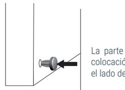
La parte rígida permite una colocación fácil y segura en el lado del orificio.
