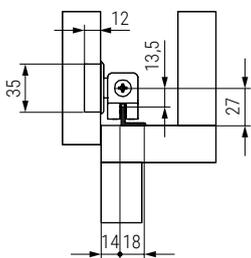
Ejemplo de sujeción a perfil inferior por debajo de la base
