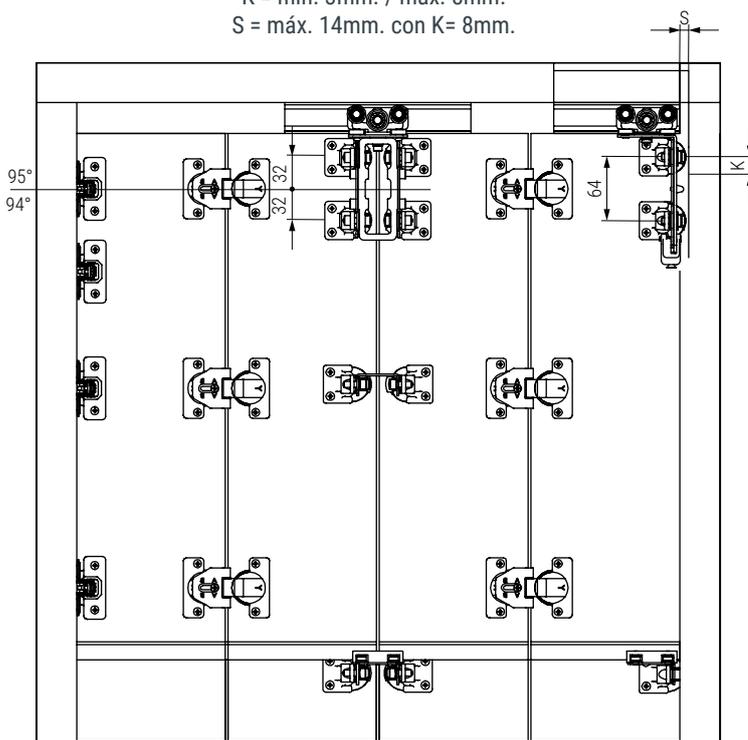
El sistema **ZIGZAG** es válido también para armarios de **4 puertas**. Para su montaje utilizaremos los mismos herrajes que para un armario de 2 puertas más algunos accesorios adicionales según esquema de montaje:
