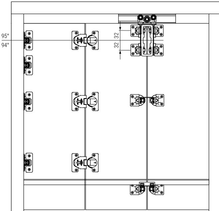
El sistema **ZIGZAG** es válido también para armarios de **3 puertas**. Para su montaje utilizaremos las mismas guías y bisagras que para un armario de 2 puertas y diferentes elementos de deslizamiento según esquema de montaje:
