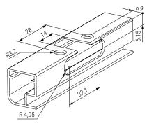
Gracias a sus dimensiones reducidas, las bisagras para perfil metálico permiten la utilización de perfiles con espesores y anchos reducidos. Los cristales se pueden colocar con juntas de gomas, garantizando así la falta de ruido, facilidad de montaje y rápida sustitución del cristal.
