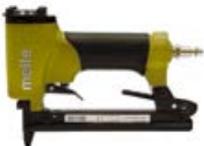
GRAPADORA GAMA ECONÓMICA MODELO ECO 8016B EMPLEA GRAPA 80 DE 7,5mm. NEUMÁTICA, PRESIÓN: 4 a 7 ATM. CÓDIGO: 372.38
