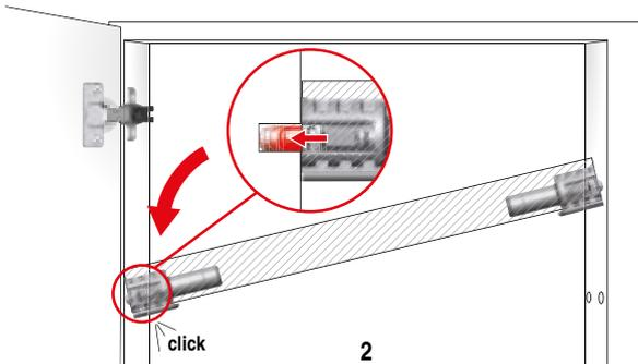
• Los soportes se sirven con la espiga hacia afuera. Lleva un muelle interior para mover la espiga hacia dentro por medio de la lengüeta para quitar el estante.
